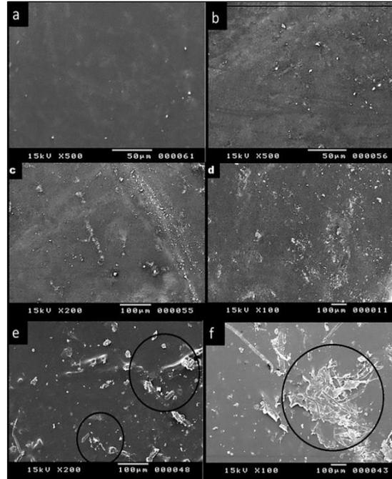
Figure (2) Shows SEM micrographs; **a.** Klucel E, **b.** 10 wt. %, **c.** 15 wt. %, **d.** 20 wt. %, **e.** 30 wt. %, **f.** 50 wt. % of CNC
